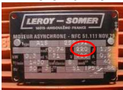
1°- Il faut regarder la plaque signalétique du moteur et repérer la plus petite tension inscrite. *Dans notre cas, la plus petite tension inscrite est 220 V. Il faut donc 220 V aux bornes de chaque enroulement du moteur.*
